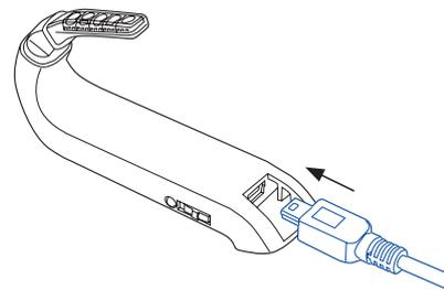
1. Соединение с кабелем
