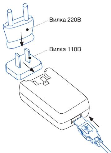
3. Соедините аппарат с платформой. Вставьте USB кабель в адаптер.
